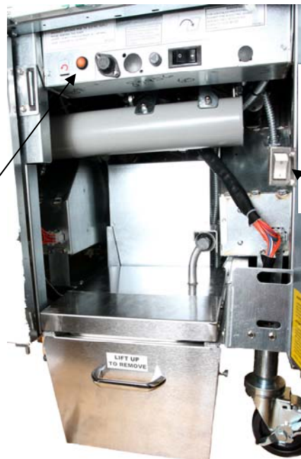
Figur 4: montert smelter Enheten er vist i posisjon.
