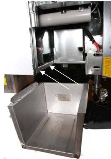
Figur 1: Plasser smelter enhet i kabinettet og feste med medfølgende skruene til kabinettet interiør.
